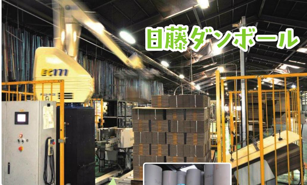
▲出来上がったダンボール箱を、ロボットがテキパキ仕分け。並べ方や積み方を自分で考える賢いロボットだよ
