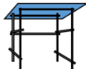
単管パイプ組による 屋根掛け小屋等
