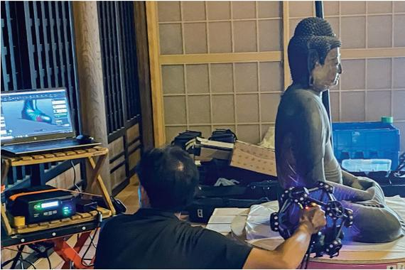
阿弥陀如来坐像の測定には、レーザーを照射して対象物の形をスキャンする計測機器が使われました。作業は回転台の上に仏像を安置して、少しずつ回してレーザーを当てる場所を変えながら計測を行います。計測したデータをコンピューター上で合成し、仏像の全体像（3Dデータ）を作ります。
