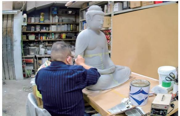
4分割された阿弥陀如来坐像は、接着剤で組み上げられます。接着剤で接合しただけでは壊れやすいため、内部に樹脂を塗る「裏打ち」という作業や補強材を仕込むことで強度を上げます。
