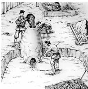
製鉄炉復元図
