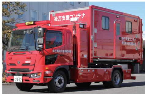
この車両は、火災や特殊災害など、災害種別に応じてそれぞれ役割の異なるコンテナ(荷台)を載せ替えることで、多目的に使用する車両です。今回は車両の更新と併せ、後方支援活動専用のコンテナを整備し、緊急消防援助隊など広域応援時の後方支援機能を強化しました。
