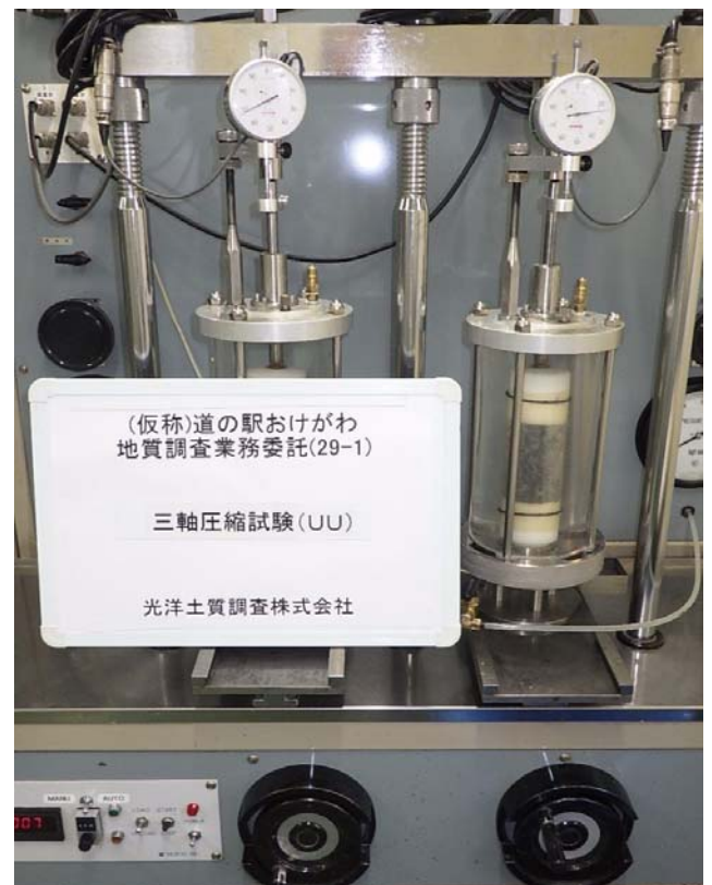
三軸圧縮試験(UU)
