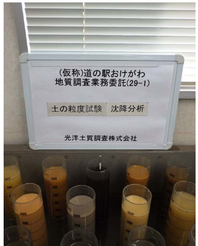
粒度試験(沈降分析)
